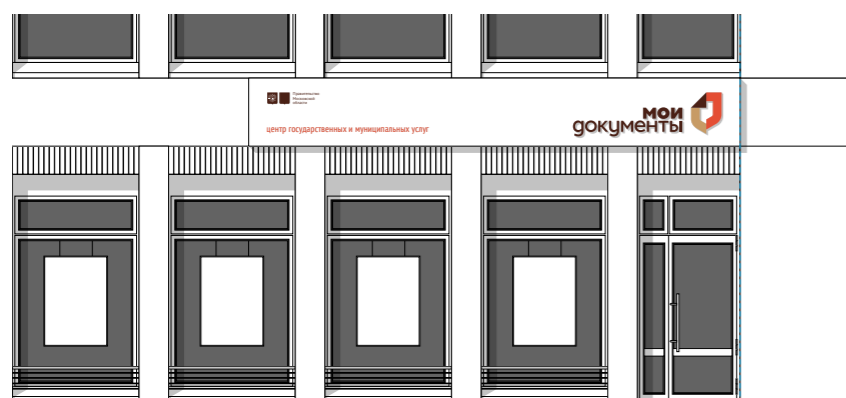
Рис. 3. При невозможности выровнять вывеску по центру дверного проёма (например, в случае его размещения возле угла здания) вывеска выравнивается по проёму одной из своих боковых сторон.
